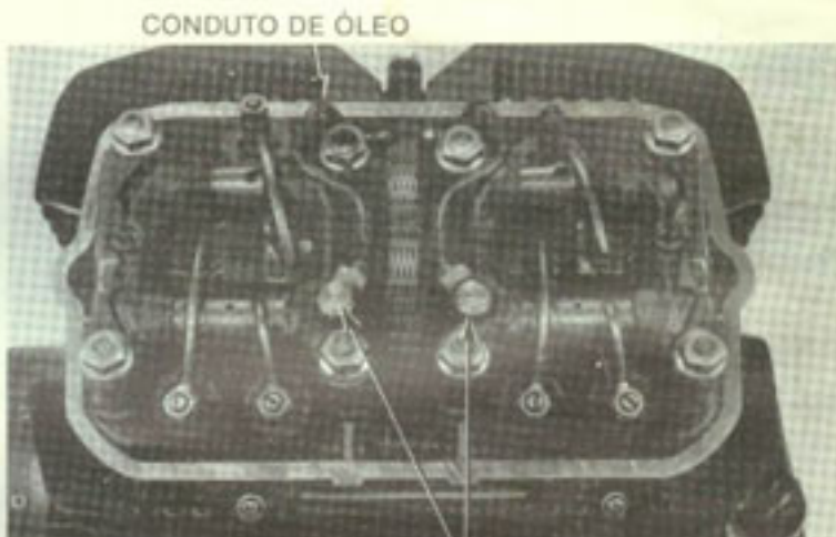
PARAFUSOS DE FIXAÇÃO DO CONDUTO
