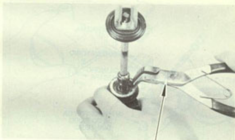
ALICATE DA TRAVA DO CILINDRO
